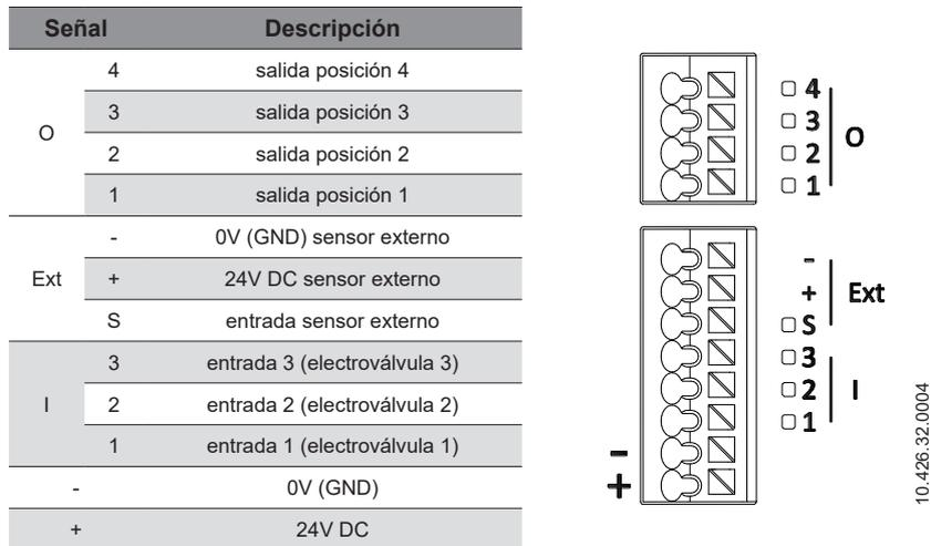
Diagrama de conexión comunicación digital 24 V DC para 0/1 electroválvula y 3 salidas:
